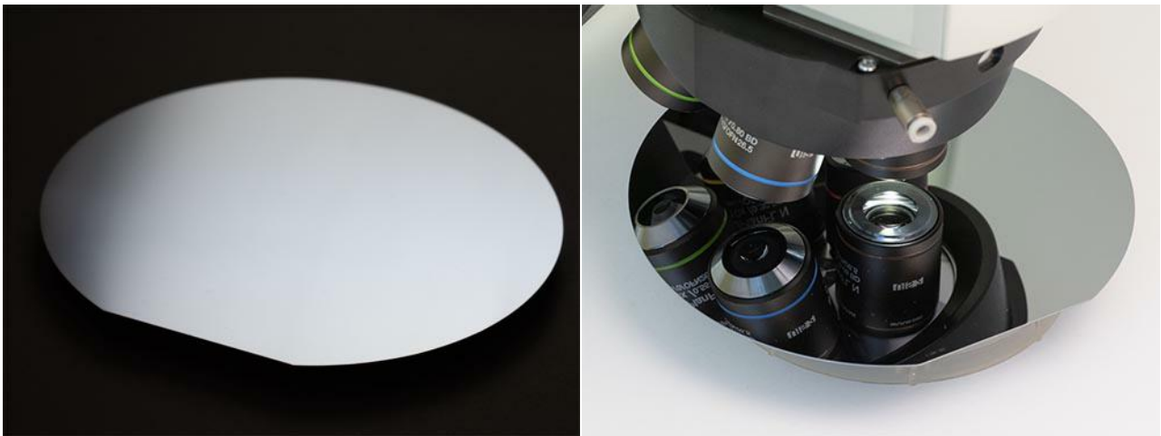
Figura 1. Inspeção de wafer desprotegido.
